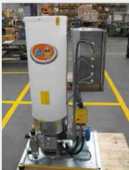
Pompa SUMO – półprzezroczysty zbiornik, z czujnikiem ciśnienia końca linii oraz sterownikiem w obudowie ze stali nierdzewnej.
