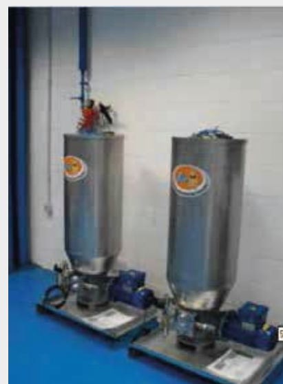
Pompa SUMO ATEX ze stali nierdzewnej 316 z silnikiem i zbiornikiem Ex d.
